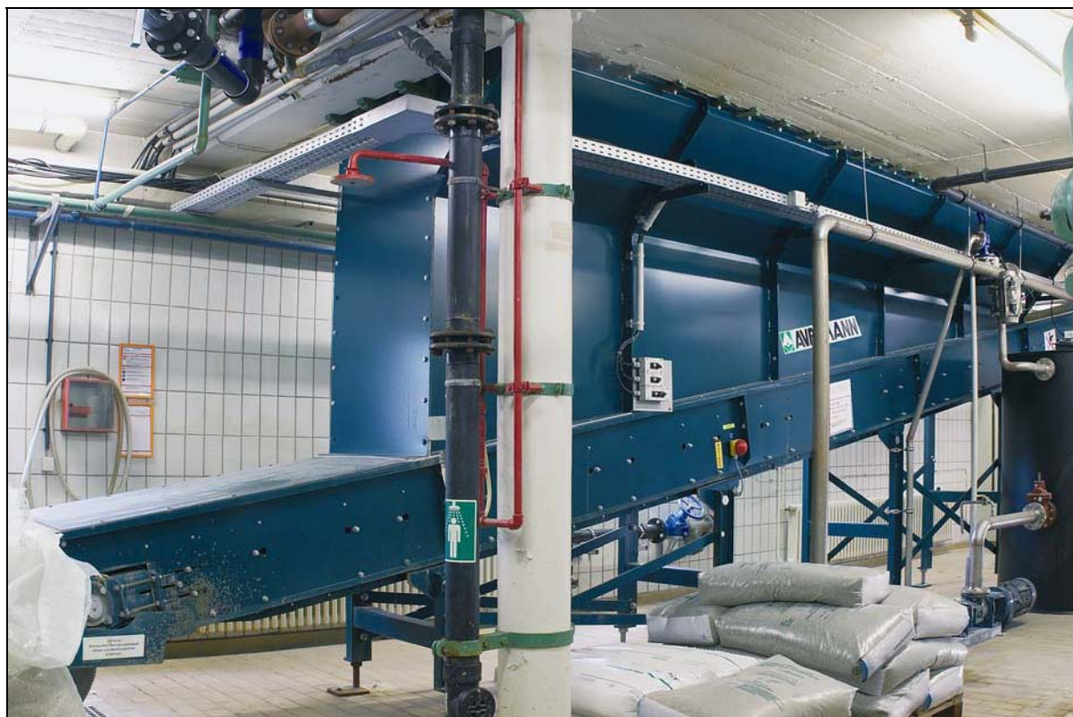
Ταινιόδρομος ολισθαίνοντος μάντα με ειδική χοάνη τροφοδοσίας
