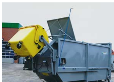
Ανυψωτικό κάδων ενσωματωμένο στο συμπιεστή απορριμμάτων
