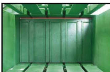
Έμβολο πίεσης ειδικού τύπου (Patent No. DE 198 60 316 A1)
