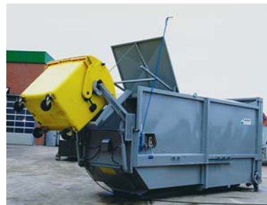
Ανυψωτικό κάδων ενσωματωμένο στο συμπιεστή απορριμμάτων
