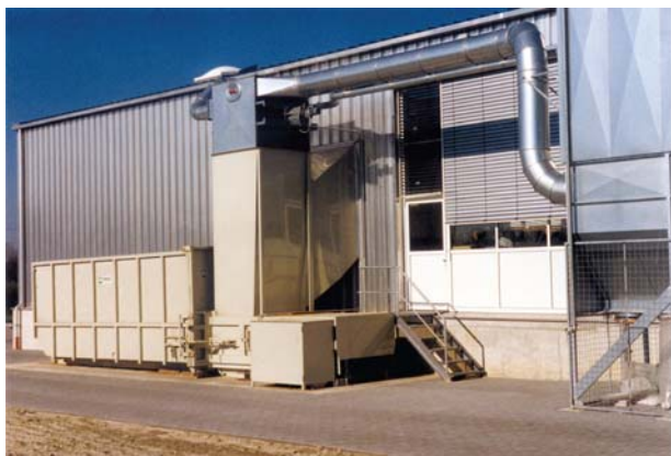
Στατική πρέσα με container, χοάνη φόρτωσης και προσαρμοσμένη μονάδα εξαγωγής και τροφοδοσίας
